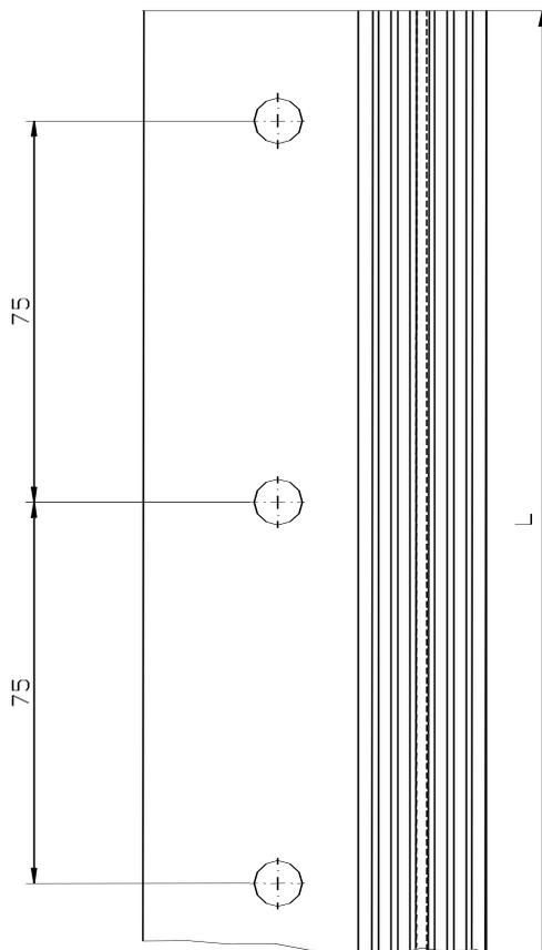
**Vertikales Verbindungsprofil – "villerit Verbindungsschiene" (Abmessungen in Millimetern)**
