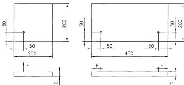
**Bild 4:** zentrischer Zug bzw. Querzug für einen Randabstand 50 / 50 mm
