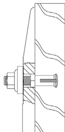
KEIL Hinterschnittanker KH
