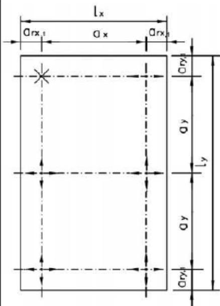
**Bild 13:** Fassadenplatte mit 6 Agraffen – Lagerungsart 2
