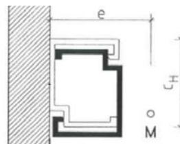
$e$  = Abstand zwischen Rückseite Fassadenplatte und Schubmittelpunkt des Horizontalprofils (s. Bild 8)
