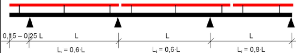
**Bild 11:** Ideelle Stützweite
