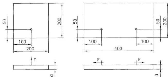
**Bild 5:** zentrischer Zug bzw. Querzug für einen Randabstand 50 / 100 mm
