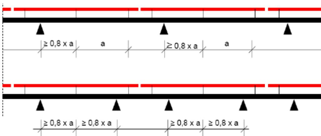
**Bild 10:** Bei Schienen, auf denen sich 3 Befestigungspunkte einer Platte befinden, müssen die mittleren Befestigungspunkte mindestens einen Abstand von  $0,8 \times a$  ( $a$  = Abstand zwischen den Befestigungspunkten der Platte) von den Auflagern haben.
