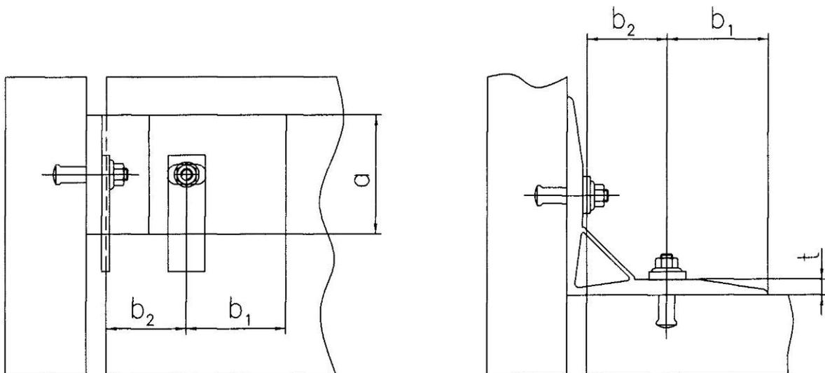
KEIL Hinterschnittanker KH
