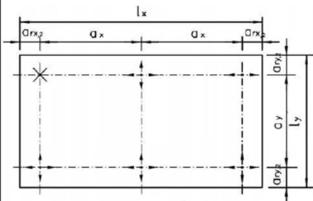
**Bild 14:** Fassadenplatte mit 6 Agraffen – Lagerungsart 3
