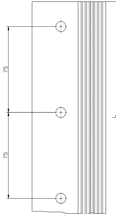
**Vertikales Verbindungsprofil – "Verbindungsleiste PVC" (Maße in mm)**
