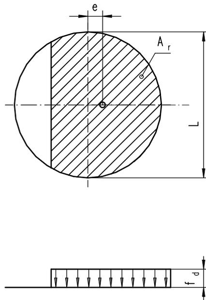
Abb. C.1 - Reduzierte Kontaktfläche  $A_r$  in kreisförmigen Gleitflächen
