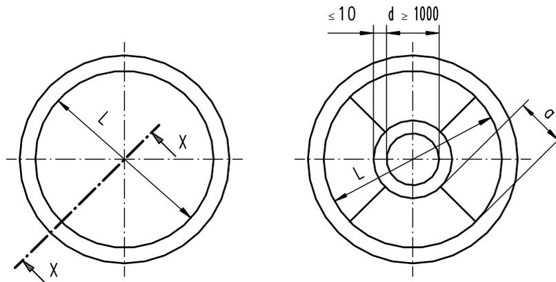
Abb. B.3 - Unterteilung gekammerter MPE-Platten für kugelige Gleitflächen
