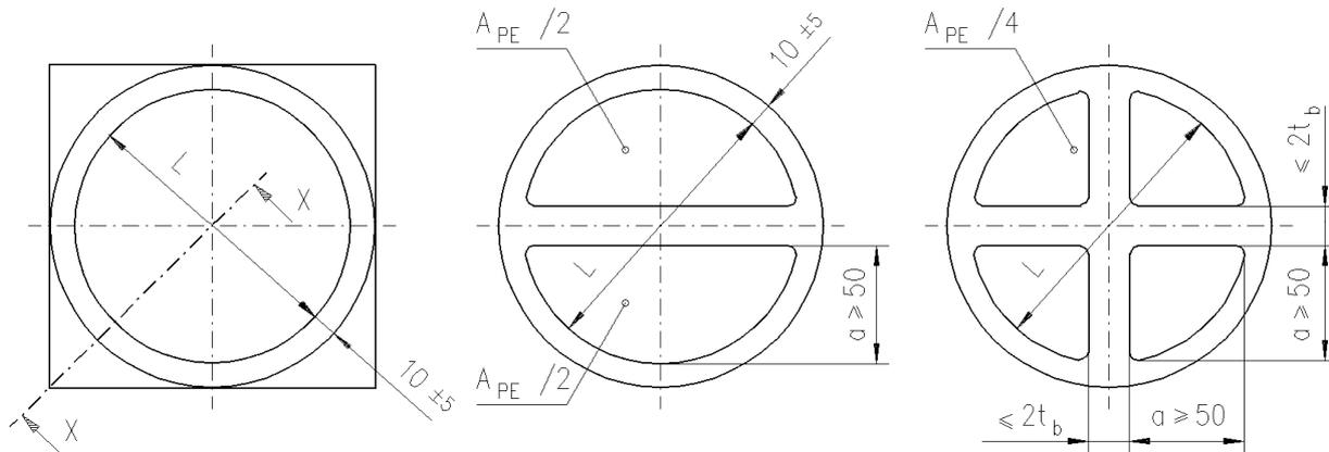
Abb. B.2 - Beispiele für die Ausbildung gekammerter ebener MPE-Platten
