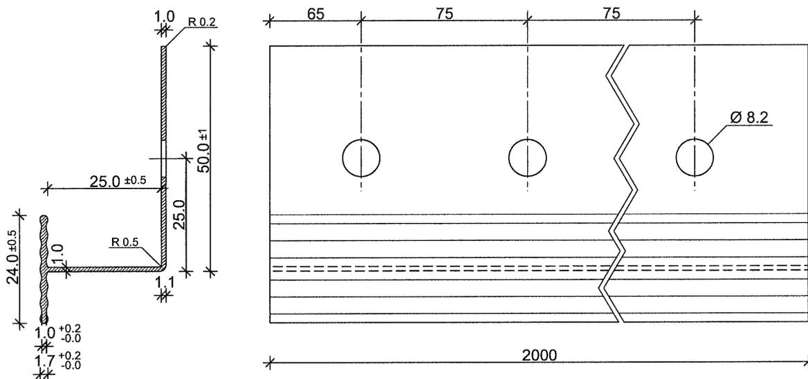
**Vertikales Verbindungsprofil "Brillux WDVS Alu-Verbindungsleiste 3580" (Maße in mm)**
