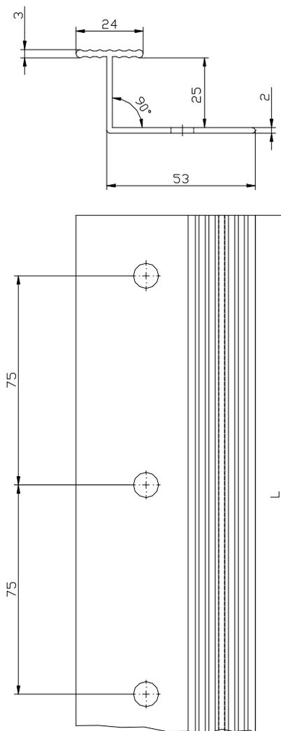
**Vertikales Verbindungsprofil "RESOTHERM Verbindungsleiste" (Abmessungen in mm)**
