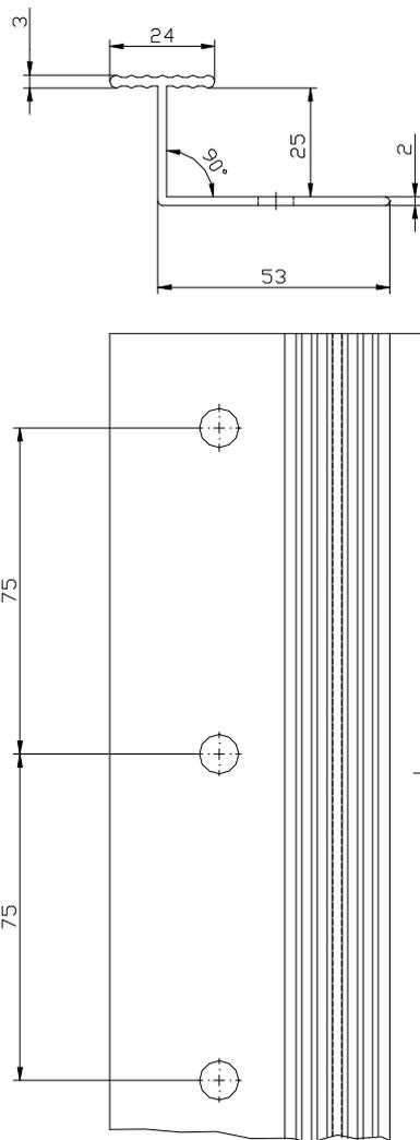
**Vertikales Verbindungsprofil "Verbindungsleiste PVC" (Maße in Millimetern)**
