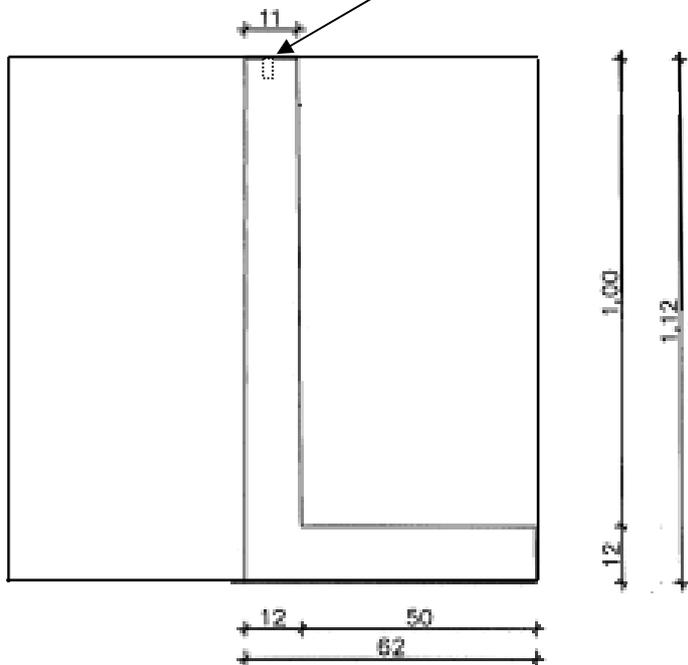
Fertigteillängen der L-Stütz- und Eck-Stützelemente: 1260 mm bis 2250 mm
