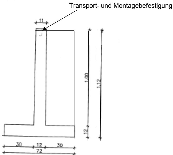
Fertigteillängen der T-Stütz- und Eck-Stützelemente: 1260 mm bis 2250 mm
