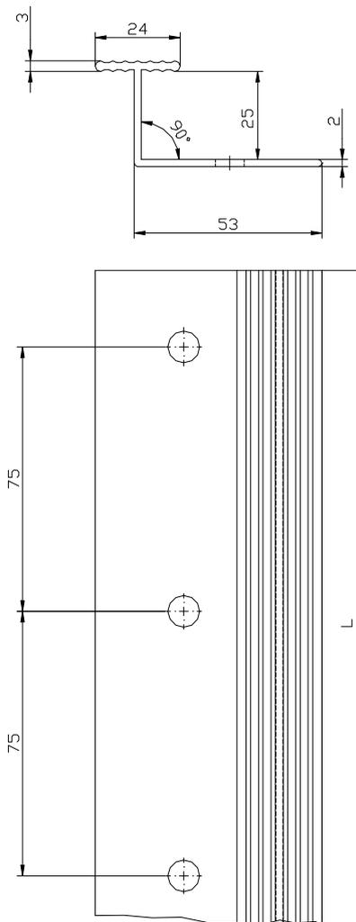
**Vertikales Verbindungsprofil "HAERING Verbindungsleiste PVC" (Maße in Millimetern)**
