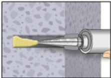
6. Gereinigtes Bohrloch vom Bohrlochgrund her ca. zu 2/3 mit Verbundmörtel befüllen. Langsames Zurückziehen des Statikmischers aus dem Bohrloch verhindert die Bildung von Lufteinschlüssen. Bei Verankerungstiefen größer 190 mm passende Mischerverlängerung verwenden. Für die Horizontal- oder Überkopfmontage sind Verfüllstutzen gemäß Anhang 8 und Mischerverlängerungen zu verwenden. Die temperaturrelevanten Verarbeitungszeiten (Tabelle 4) sind zu beachten.
