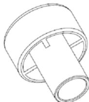
**Verfüllstutzen für Überkopf- oder Horizontalmontage**
