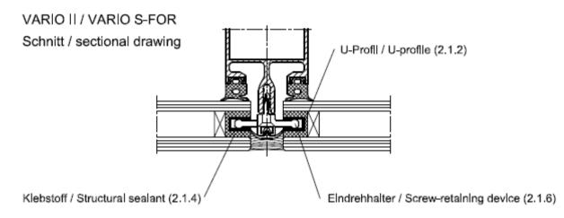
VARIO II / VARIO S-FOR in Deutschland nur bis zu einer Einbauhöhe von 8 m VARIO II / VARIO S-FOR in Germany only up to 8 m height
