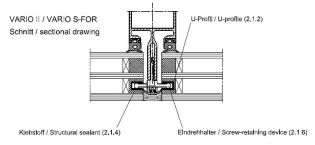
VARIO II / VARIO S-FOR in Deutschland nur bis zu einer Einbauhöhe von 8 m VARIO II / VARIO S-FOR in Germany only up to 8 m height
