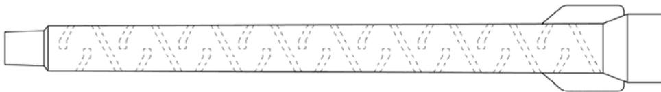
Nutzungskategorie: - Einbau in trockenem, feuchtem Beton oder wassergefülltes Bohrloch
