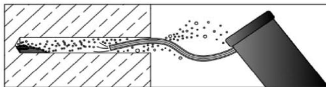
2. Bohrloch reinigen
