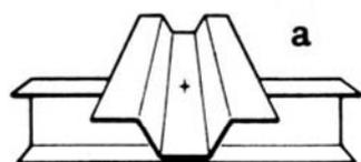
Verbindung mit einem Einzelblech
