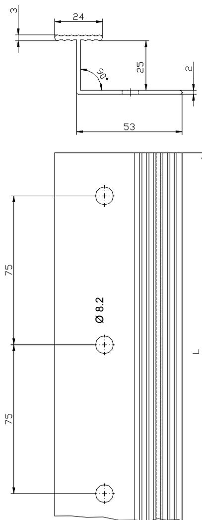
**Vertikales Verbindungsprofil "FEMA-Verbindungsleiste PVC" (Maße in mm)**
