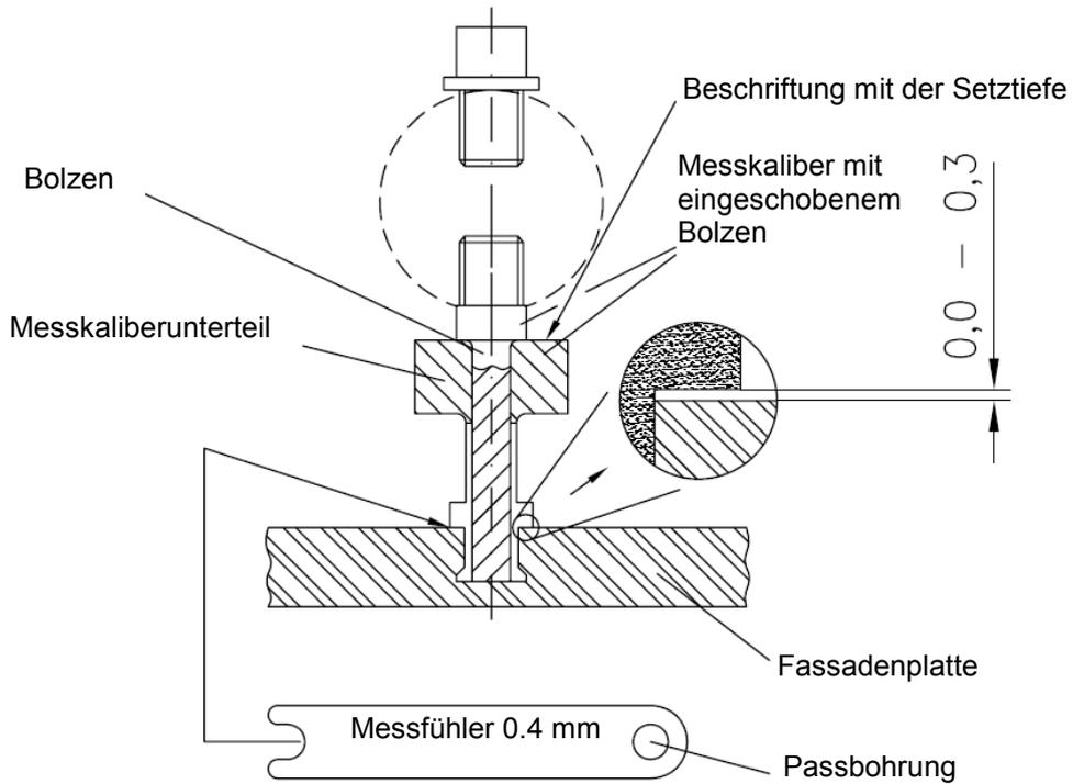
KEIL Hinterschnittanker KH für Fassadenplatten HI-MACS(R) Typ: Alpine White
