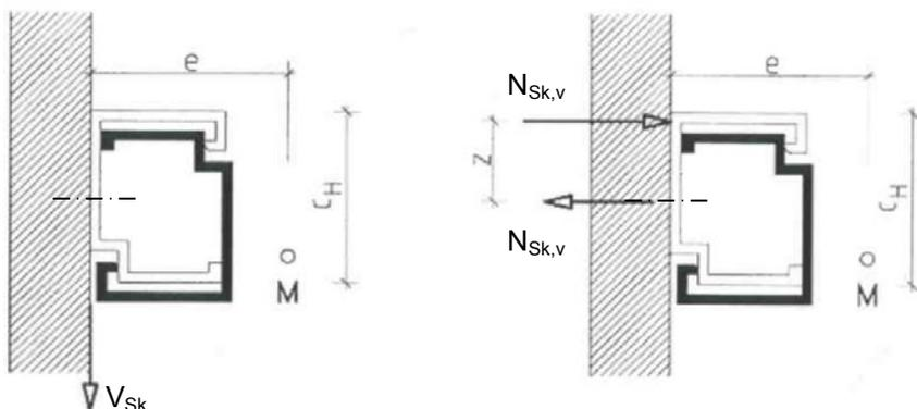
KEIL Hinterschnittanker KH für Fassadenplatten HI-MACS(R) Typ: Alpine White
