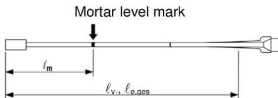
$$l_m = l_v \text{ resp. } l_{e,ges} \cdot \left( 1,2 \cdot \frac{d_s^2}{d_0^2} - 0,2 \right) \text{ [mm]}$$
