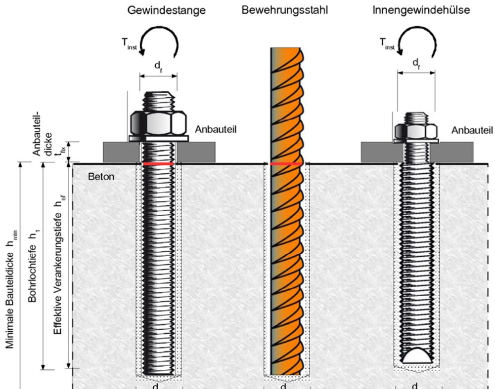
DEWALT PURE150-PRO Verbundmörtel mit Ankerstange in Beton
