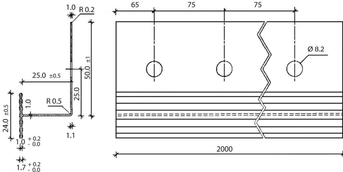
**Vertikales Verbindungsprofil – "muro Verbindungsleiste Alu"** (Abmessungen in mm)
