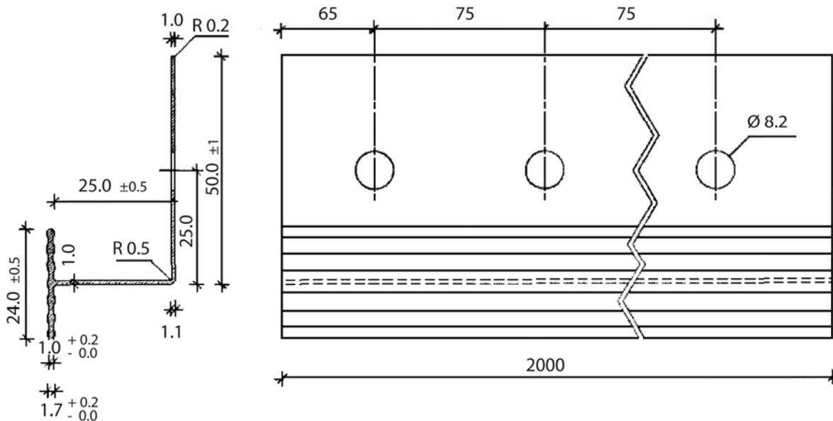
**Vertikales Verbindungsprofil – "INTRATHERM Verbindungsleiste Alu"** (Abmessungen in mm)
