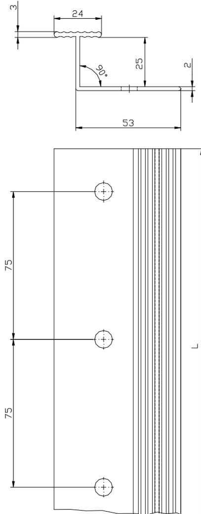
**Vertikales Verbindungsprofil "muro Verbindungsleiste PVC" (Maße in mm)**
