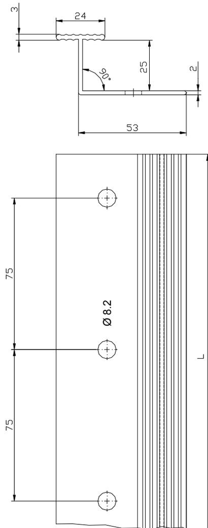
**Vertikales Verbindungsprofil – "PVC-Verbindungsleiste" (Maße in Millimetern)**
