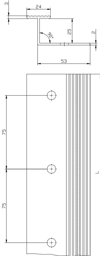
**Vertikales Verbindungsprofil "Verbindungsleiste PVC" (Maße in mm)**
