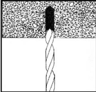
Loch mit geprüften Hammerbohrer  $\varnothing 6\text{mm}$  min. 50mm bohren
