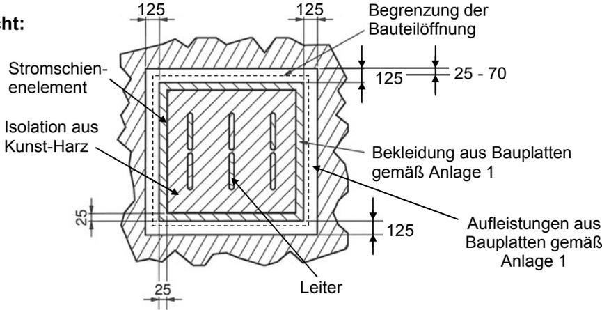
Ausrichtung der Leiter bei Wandeinbau: vertikal
