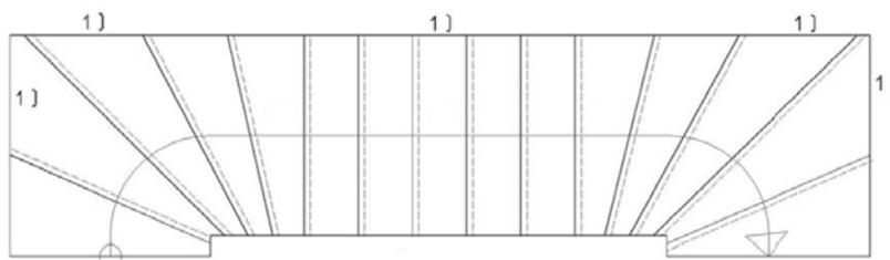
1) Zusätzliche Auflager für Vertikallasten
