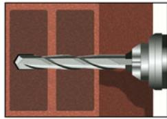
3. Bohrloch (ohne Hammerschlag) mit Bohrerdurchmesser und Bohrlochtiefe entsprechend der Ankergröße und Einbindetiefe des gewählten Dübels im Verankerungsgrund erstellen.
