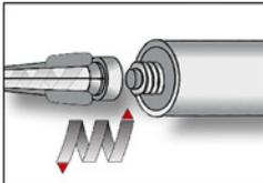
1. Den mitgelieferten Statikmischer auf die Kartusche aufschrauben und Kartusche in eine geeignete Auspresspistole einlegen. Den Schlauchfolienclip vor der Verwendung abschneiden. Bei jeder Arbeitsunterbrechung länger als die empfohlene Verarbeitungszeit (Tabelle 5) und bei jeder Kartusche ist der Statikmischer zu erneuern.
