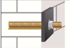
9. Nach vollständiger Aushärtung kann das Anbauteil mit dem maximalen Drehmoment (Tabelle 3 und 4) montiert werden. Die Mutter muss mit einem geeichten Drehmomentschlüssel festgezogen werden.
