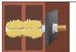
9. Nach vollständiger Aushärtung kann das Anbauteil mit dem maximalen Drehmoment (Tabelle 4) montiert werden. Die Mutter muss mit einem geeichten Drehmomentschlüssel festgezogen werden.
