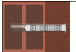
5. Siebhülse in das Bohrloch einfügen. Sicherstellen, dass die Siebhülse optimal ins Bohrloch passt. Die Siebhülse niemals kürzen. Nur Siebhülsen mit richtiger Länge verwenden.
