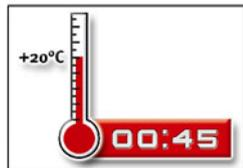
8. Die angegebene Aushärtezeit muss eingehalten werden. Der Anker darf vor Erreichen der Aushärtezeit (Tabelle 5) nicht bewegt oder belastet werden.
