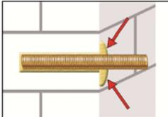
7. Sicherstellen, dass der Ringspalt komplett mit Mörtel ausgefüllt ist. Tritt kein Mörtel nach Erreichen der Setztiefe heraus, ist die Installation zu wiederholen.
