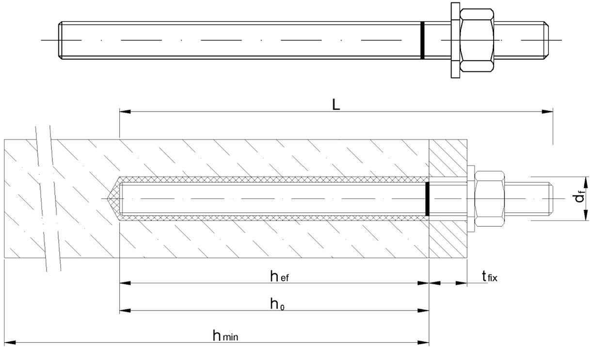
Betonstahl  $\varnothing 10, \varnothing 12, \varnothing 14, \varnothing 16, \varnothing 20, \varnothing 25$  gemäß Anhang 4
