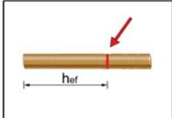
4. Vor dem Injizieren des Mörtels die geforderte Setztiefe auf der Ankerstange markieren.
