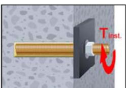
10. Nach vollständiger Aushärtung kann das Bauteil mit dem zulässigen Drehmoment (Tabelle 2) montiert werden. Die Mutter muss mit einem geeigneten Drehmomentschlüssel festgezogen werden.
