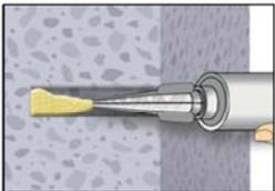
6. Gereinigtes Bohrloch vom Bohrlochgrund her ca. zu 2/3 mit Verbundmörtel befüllen. Langsames Zurückziehen des Statikmischers aus dem Bohrloch verhindert die Bildung von Luftporen. Für Setztiefen größer 190 mm passende Mischerverlängerung verwenden. Für die Horizontal- oder Überkopfmontage von Ankern  $> \varnothing 20$  mm sind Verfüllstutzen gemäß Anhang 8 zu verwenden. Die temperaturrelevanten Verarbeitungszeiten (Tabelle 4) sind zu beachten.
