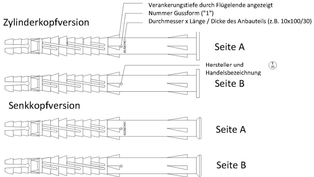
**Spezialschraube (galvanisch verzinkter Stahl und rostfreier Stahl - A4)**
