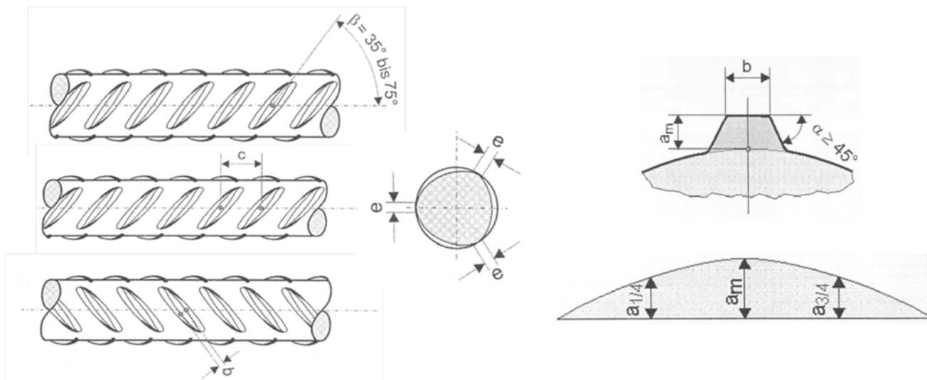
Tabelle 1: kaltverformter, gerippter Betonstahl in Ringen, B500 NR
