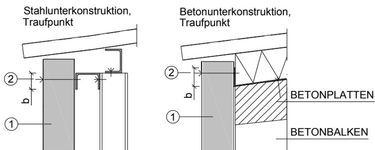
Endauflagerbreite  $b \geq 40 \text{ mm}$
