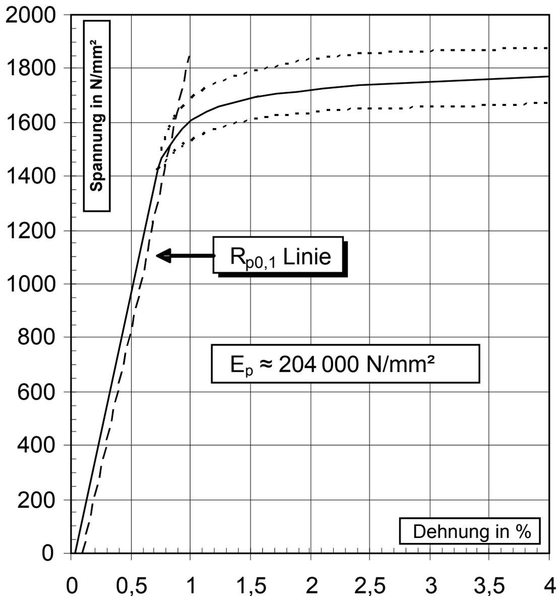
Die gestrichelten Linien markieren etwa den Bereich, innerhalb dessen die tatsächlichen Spannungs-Dehnungslinien auftreten können.
