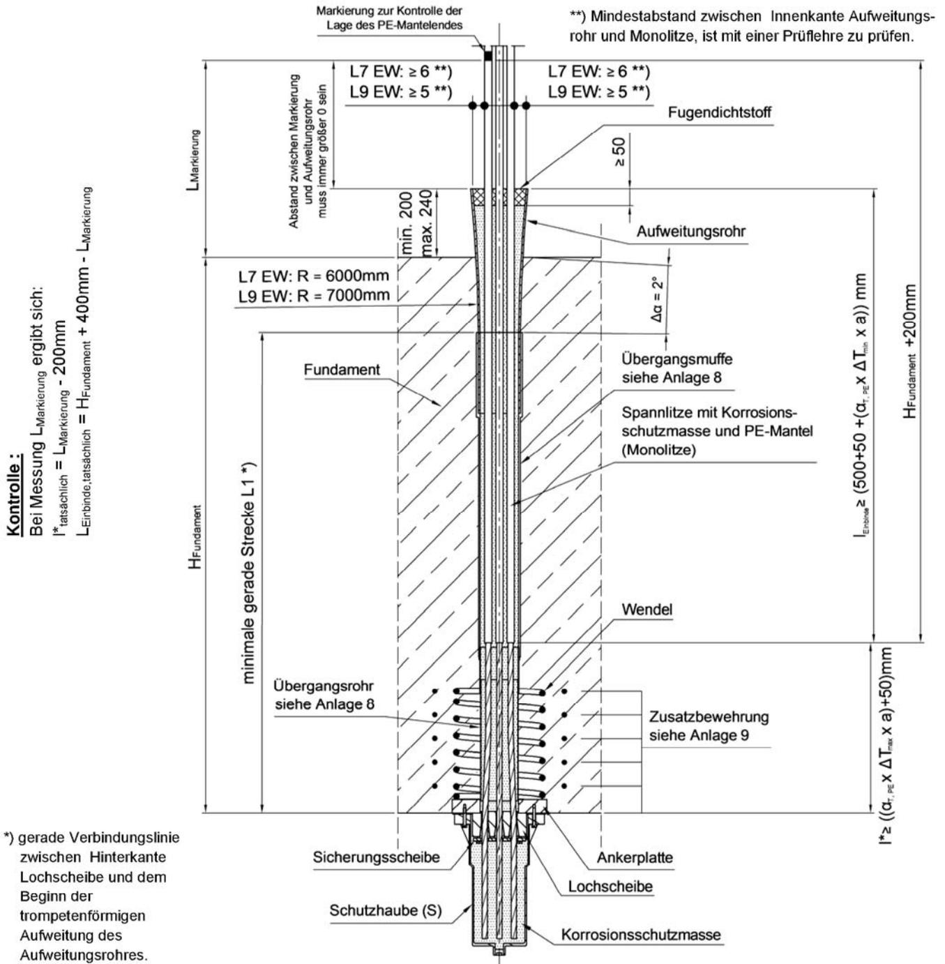
Mindesteinbindelänge PE-Mäntel in die Korrosionsschutzmasse: 500 mm
