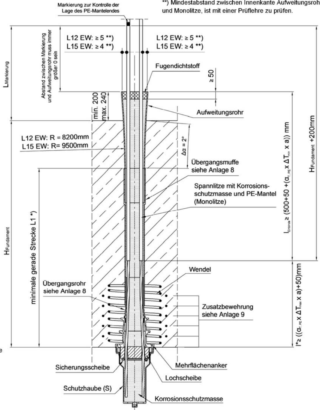
\*) gerade Verbindungslinie zwischen Hinterkante Lochscheibe und dem Beginn der trompetenförmigen Aufweitung des Aufweitungsrohres.
