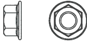
Mutter M10 sperrverzahnt DIN 6923 (A2-70)
