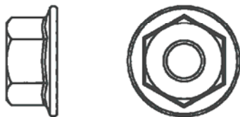
Mutter M8 sperrverzahnt SW15, ähnl. DIN 6923 (A2-70)
