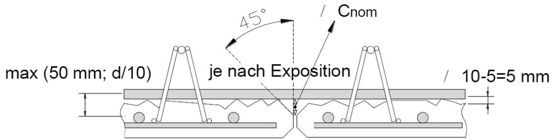
Erforderliche Betondeckung für eine Querbewehrung von Elementdecken nach DIN 1045-1 bzw. DIN EN 1992-1-1:2011-01 und DIN EN 1992-1-1/NA:2011-01
