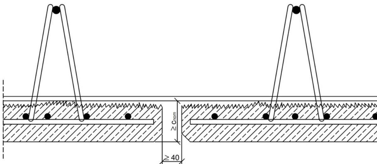
Für die Betondeckung im Ortbeton ist Abschnitt 4.2 der Zulassung zu beachten.
