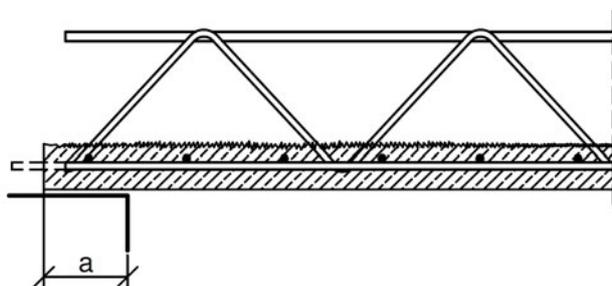
Auflagerung ohne Montageunterstützung am Rand, wenn  $a \geq 35\text{mm}$  ist und die Bedingungen nach Abschnitt 3.3.2 erfüllt sind.
