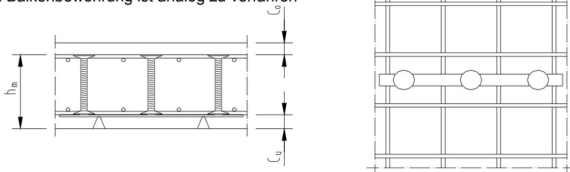
Betondeckung  $C_u$  und  $C_o$  nach DIN 1045-1:2008-08, Abschnitt 6.3 oder DIN EN 1992-1-1, Abschnitt 4.4.1 unter Beachtung von DIN EN 1992-1-1/NA, NCI und NDP zu 4.4.1
