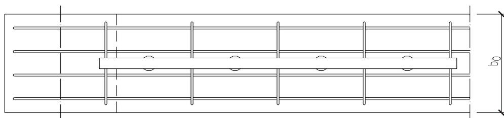
**Abstände  $S_{L,PSB}$  der PSB-S-Anker in Richtung der Biegebeanspruchung nach Tabelle 1. Bei Balken mit  $h < 20 \text{ cm}$  und  $V_{Ed} < 0,3 V_{Rd,max}$  braucht der Abstand nicht kleiner als 15 cm zu sein.**
