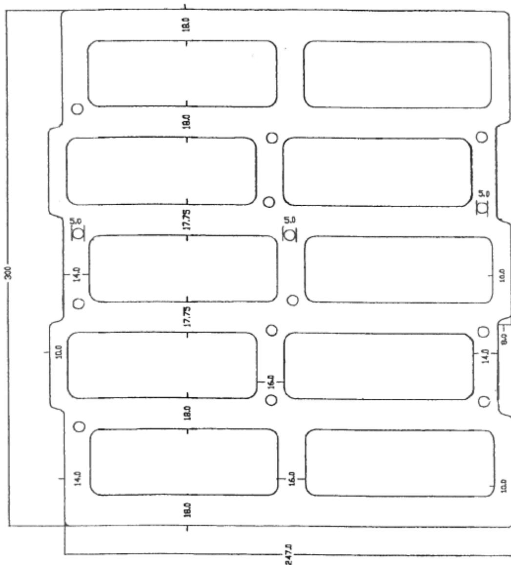
Mauerwerk aus THERMOPOR Planhochlochziegeln mit integrierter Wärmedämmung
