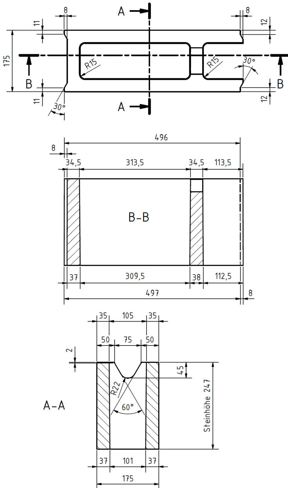
Wandbauart aus Rohloff Schalungssteinen aus Beton
