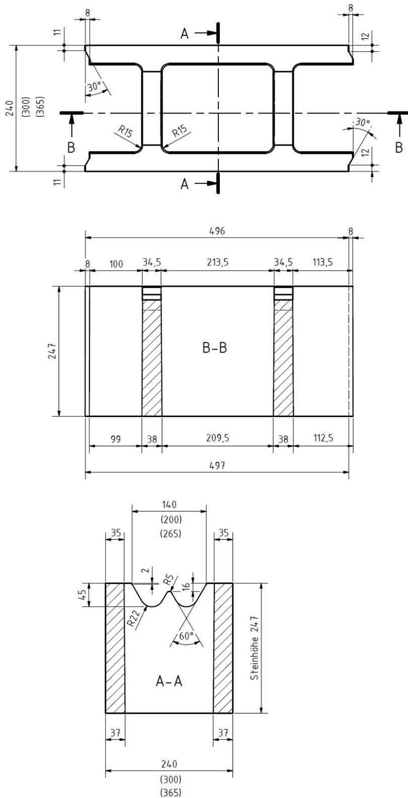
Wandbauart aus Rohloff Schalungssteinen aus Beton
