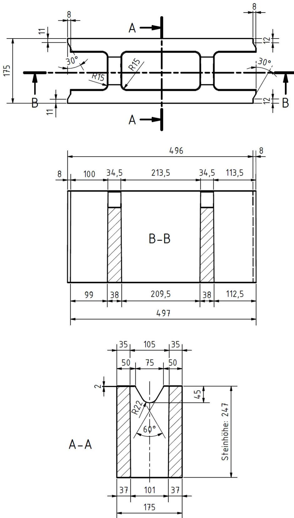
Wandbauart aus Rohloff Schalungssteinen aus Beton
