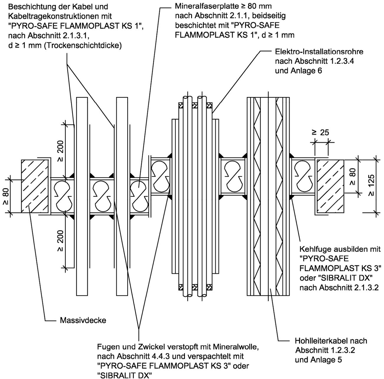
Kabelabschottung "PYRO-SAFE Universal-ONE" der Feuerwiderstandsklasse S 90 nach DIN 4102-9
