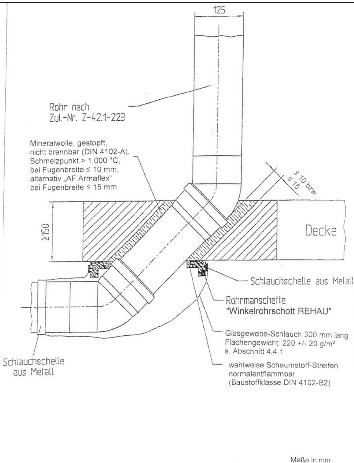
Rohrabschottung "System Winkelrohrschott REHAU"
