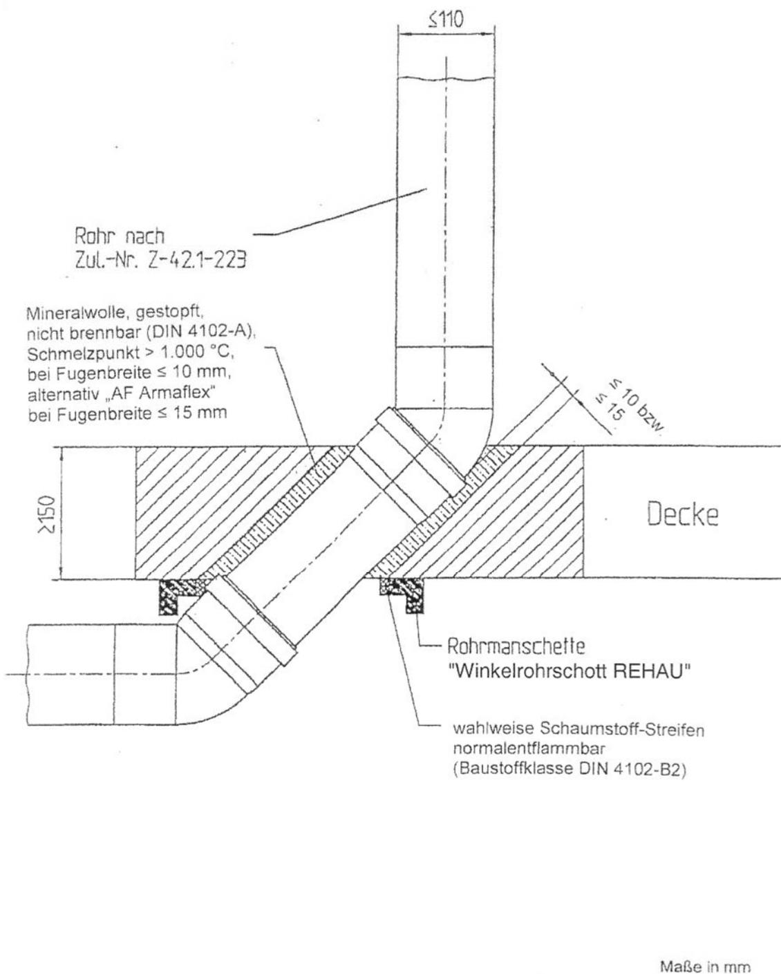
Rohrabschottung "System Winkelrohrschott REHAU"
