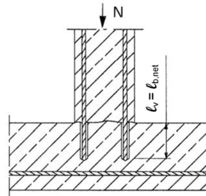
**Bild 5:** Verankerung von Bewehrung zur Deckung der Zugkraftlinien
