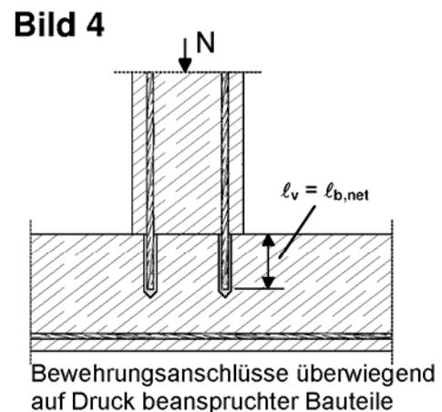
Bewehrungsanschlüsse überwiegend auf Druck beanspruchter Bauteile
