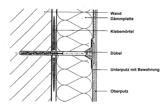
Bei der Verdübelung der Dämmstoffplatten sind die Anlagen 5.1 und 5.2 zu beachten.
