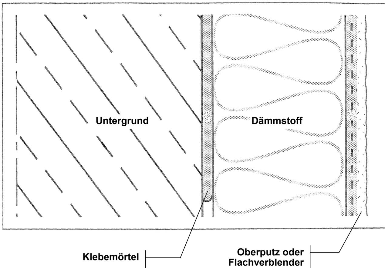
"BRILLUX Wärmedämm-Verbundsystem EPS"
