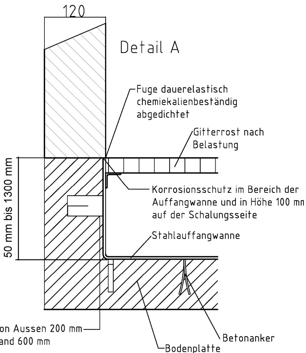
Auffangwannen aus Stahl für Gefahrstofflager aus Beton
