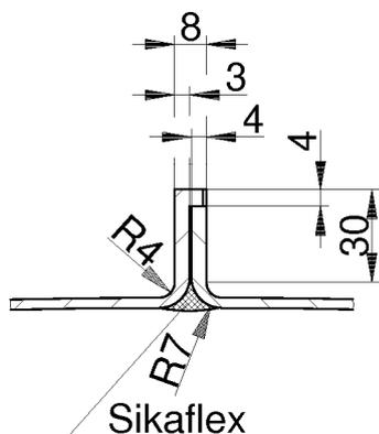
Deckelhälften werden am Mittelsteg mit 4 Scheerzahn-Schrauben M6x16, 4 Hutmuttern und 4 U-Scheiben fixiert
