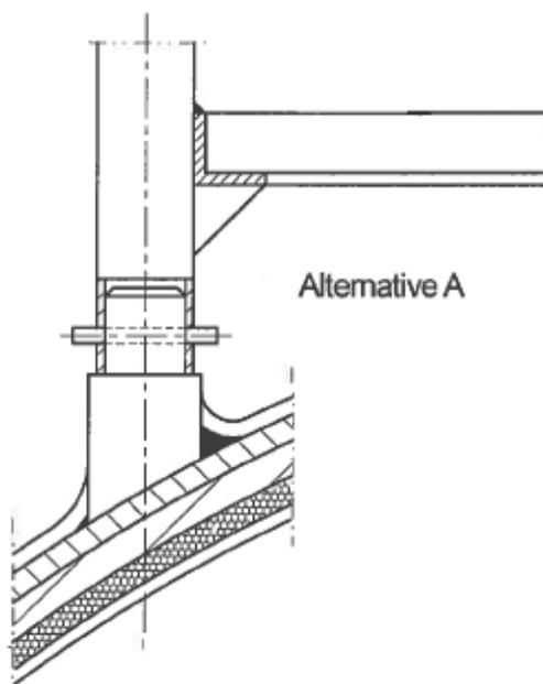
Doppelwandige liegende Behälter aus GFK mit innerer Vlies- oder Chemieschutzschicht
