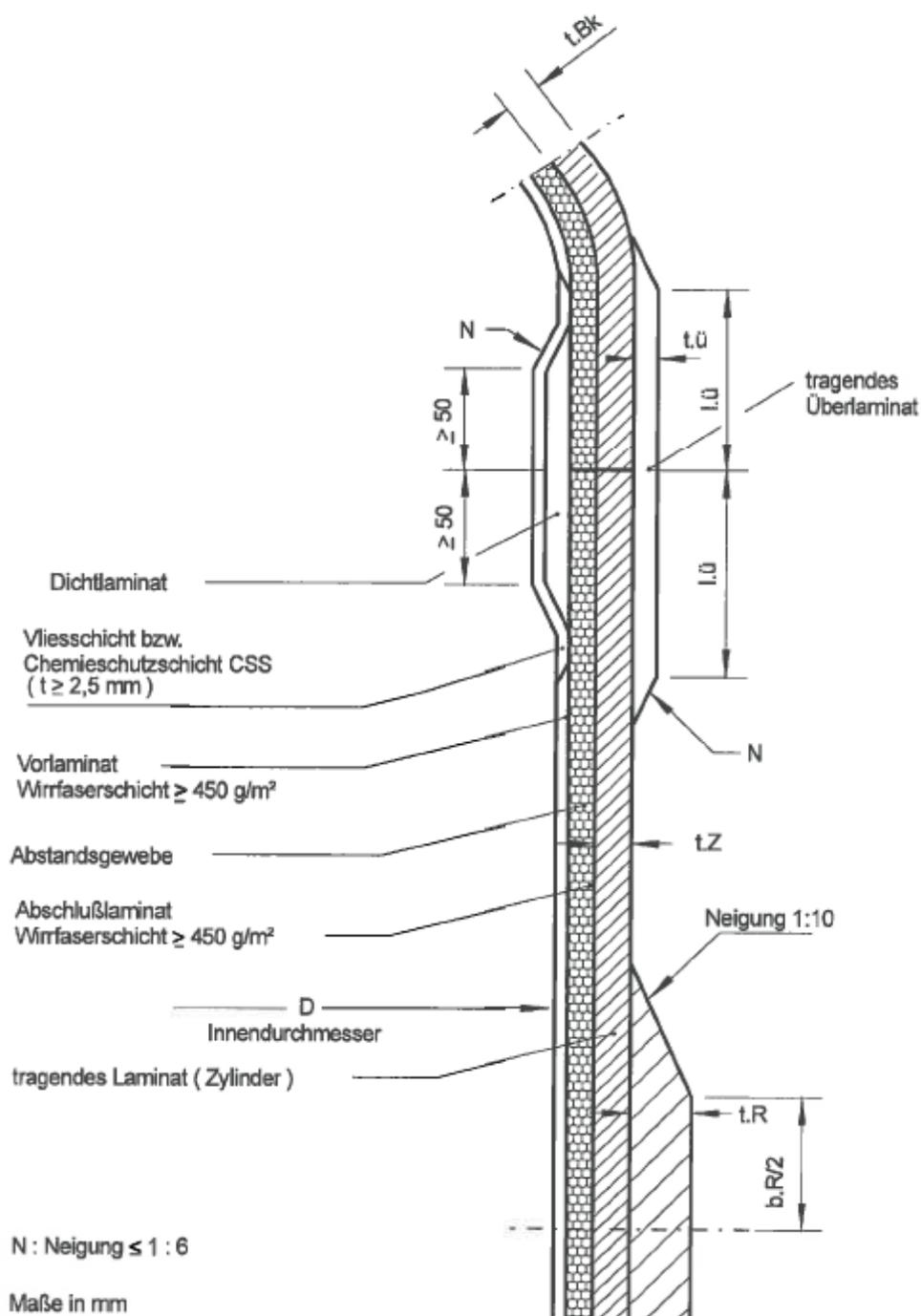
Doppelwandige liegende Behälter aus GFK mit innerer Vlies- oder Chemieschutzschicht
