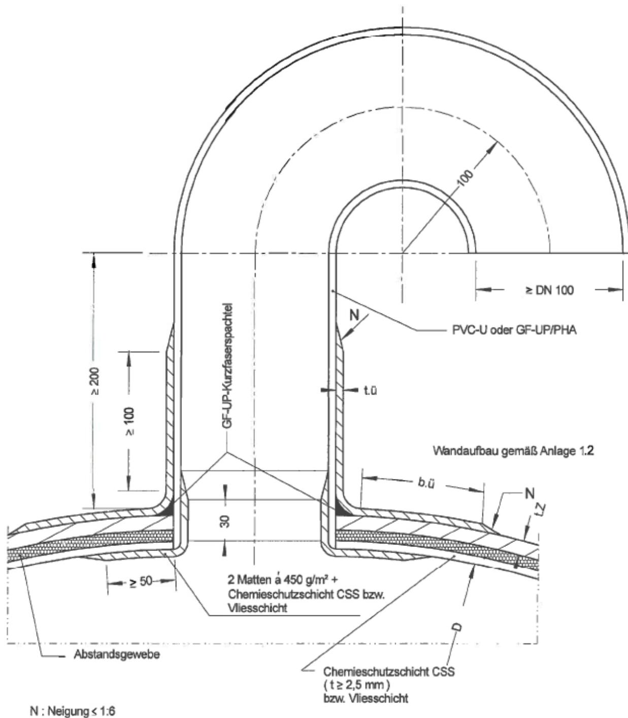
Doppelwandige liegende Behälter aus GFK mit innerer Vlies- oder Chemieschutzschicht
