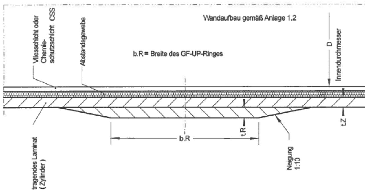
Doppelwandige liegende Behälter aus GFK mit innerer Vlies- oder Chemieschutzschicht
