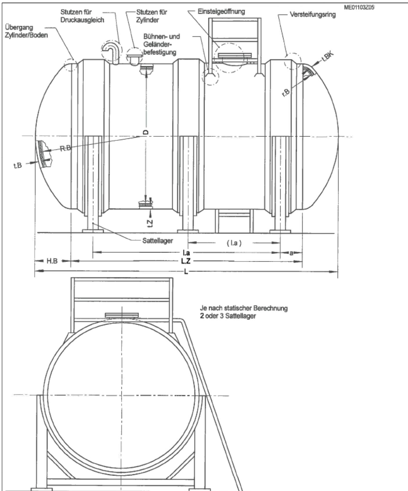
Doppelwandige liegende Behälter aus GFK mit innerer Vlies- oder Chemieschutzschicht
