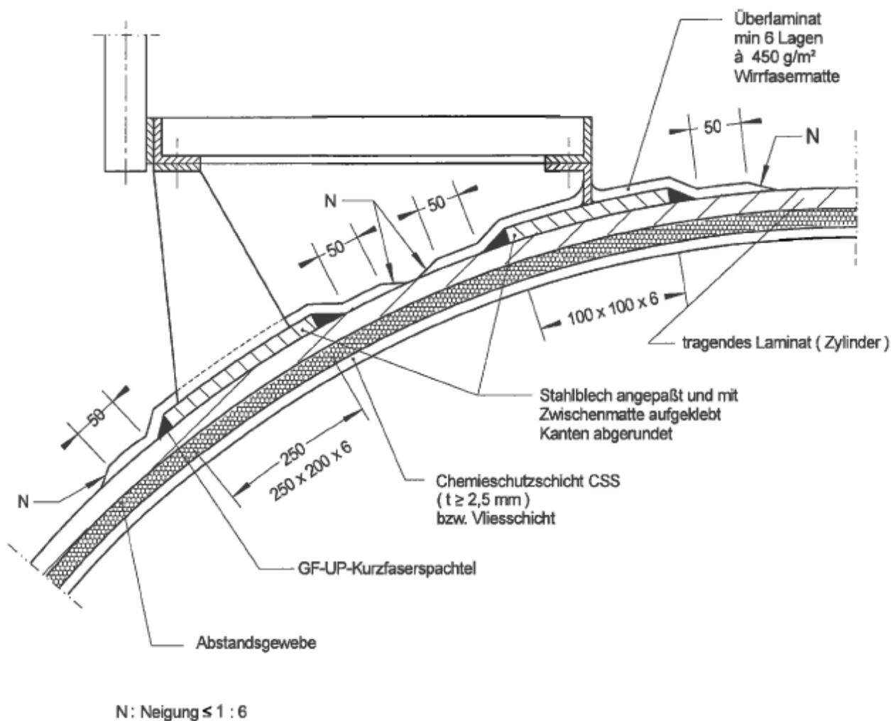
Stahlteile siehe Anlage 3 Abschnitt 3
