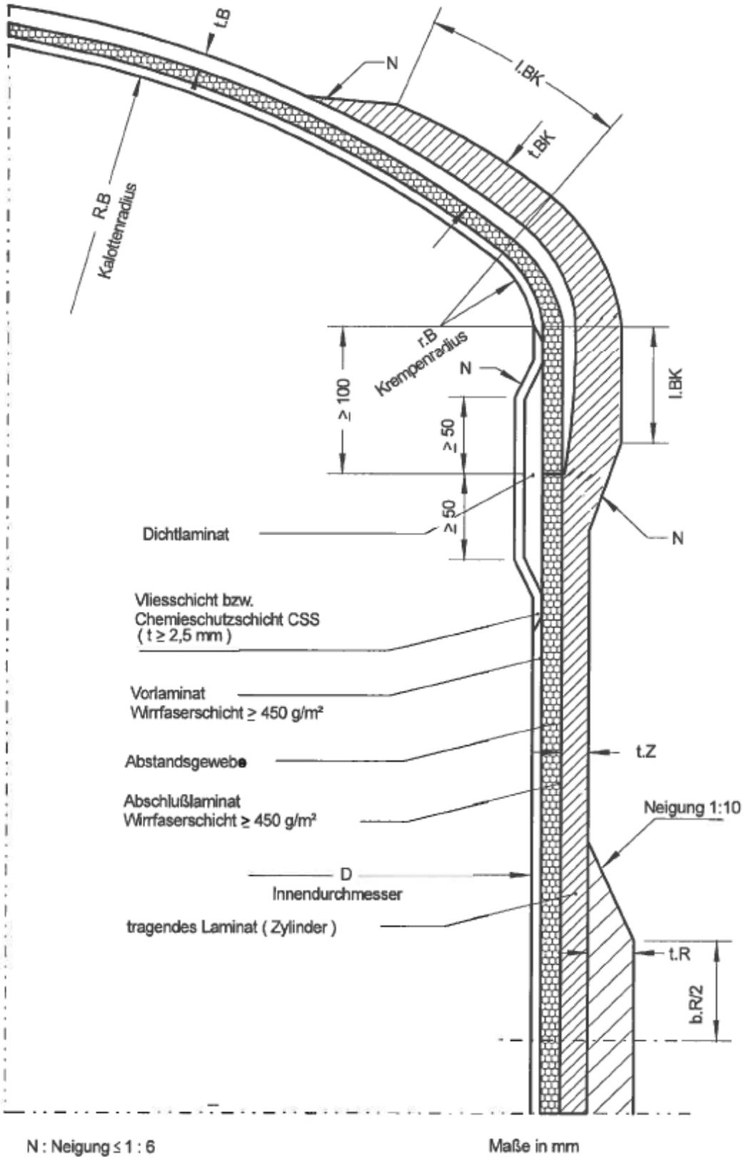
Doppelwandige liegende Behälter aus GFK mit innerer Vlies- oder Chemieschutzschicht
