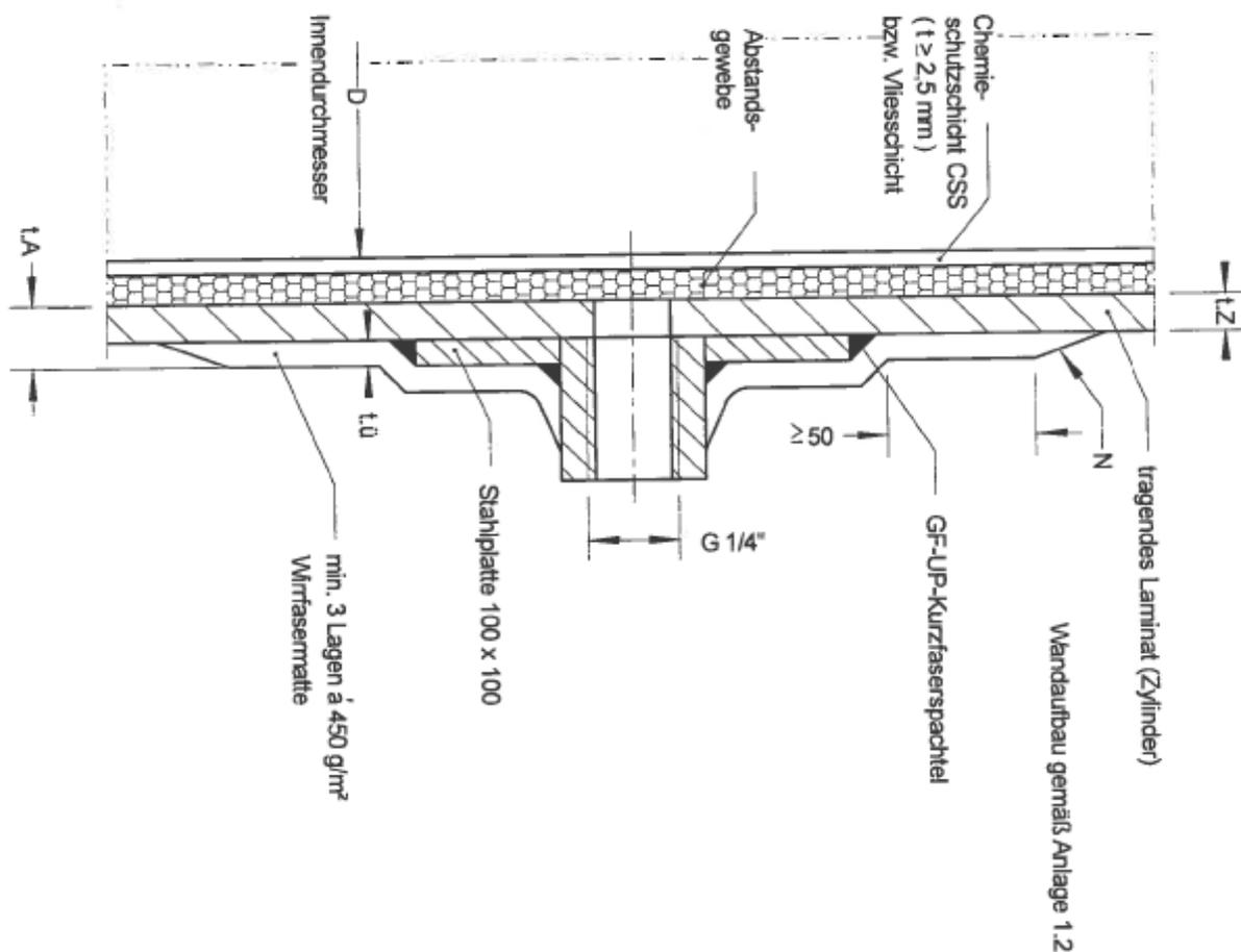
Die Darstellung zeigt den Anschluss für die Saugleitung am Behältertiefpunkt entsprechend Abschnitt 5.1.1 (2) b) der Besonderen Bestimmungen dieser allgemeinen bauaufsichtlichen Zulassung.
