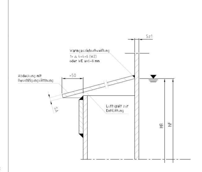
Befestigung des Regenabweisers in Abhängigkeit von hF:
