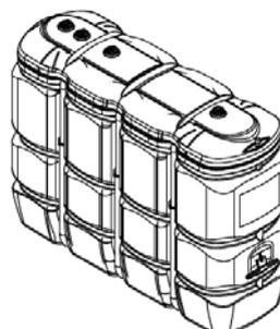
Blasgeformte Behälter mit integrierter Auffangvorrichtung aus Polyethylen (PE-HD) mit vertikalen verzinkten Stahlblechbandagen
